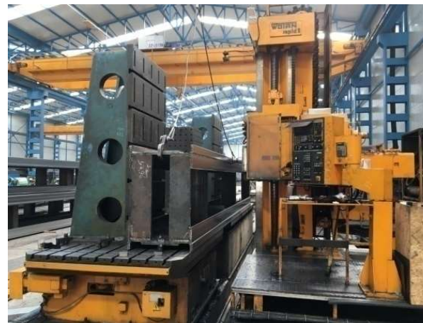
CNC HORIZONTAL MACHINING CENTER WOTAN RAPID 2K. X: 8.500 mm, Y: 2.500 mm, Z: 800 mm
