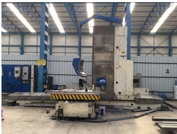
CNC BOHRWERK FIL FRESATRICI FA1000 X: 4.000mm, Y: 2.000mm, Z: 1.000mm
